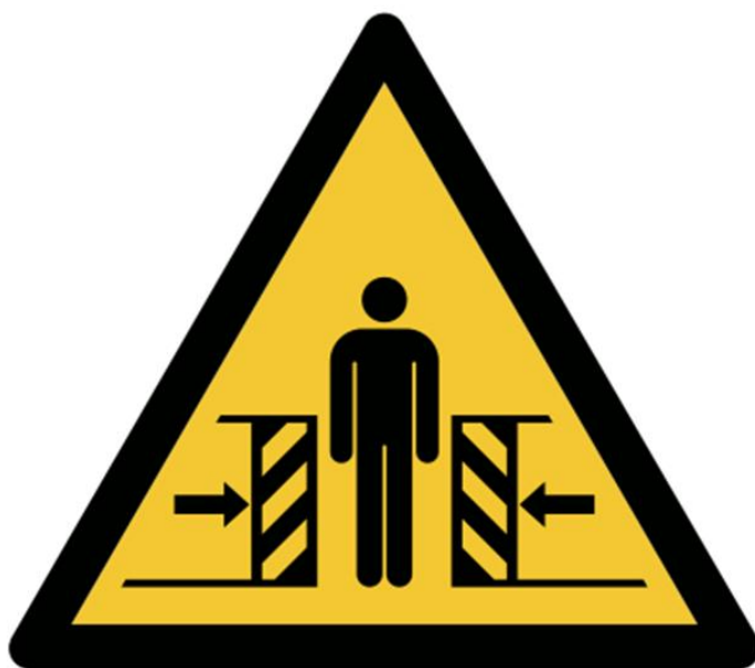
图 B.3 警告标志示例：当心挤压（GB/T 23725.3—2024 图 A.5）
