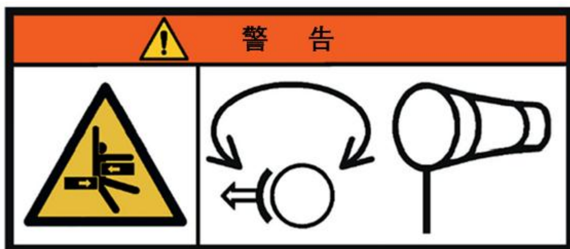
图 B.7 安全标牌示例：回转制动解锁随风向改变方位时的剪切危险（GB/T 23725.3—2024 图 A.7）
